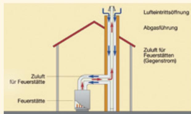
Eine zuverlässige Lösung und bei Zentralheizungen „Stand der Technik“ ist deshalb die raumluftunabhängige Luftzufuhr. Sie garantiert, dass die Feuerstätte immer genügend Verbrennungsluft bekommt und der Schornstein ordentlich zieht.
