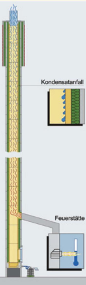
Mengen heißer Abgase. Im Schornstein entstand hoher Auftrieb, denn heiße Luft ist leichter als die Umgebungsluft. Ein einfacher, gemauerter Schornstein reichte aus, um die Abgase abzuführen.
