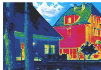
Die Thermografie wird auch zur Qualitätskontrolle am Bau oder zur Fehlersuche verwendet. Fehler können zum Beispiel bei der Fassadendämmung oder bei der Abdichtung der Fußbodenheizung entdeckt werden.
